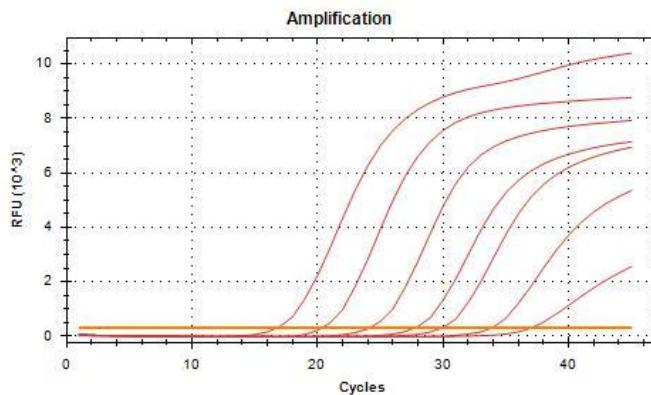
Figura 4. Diluciones seriadas de un estándar de Influenza B ( $10^7$ - $10^1$ copias/reacción). Experimento realizado en el equipo Bio-Rad CFX96™ Real-Time PCR Detection System (canal ROX).
