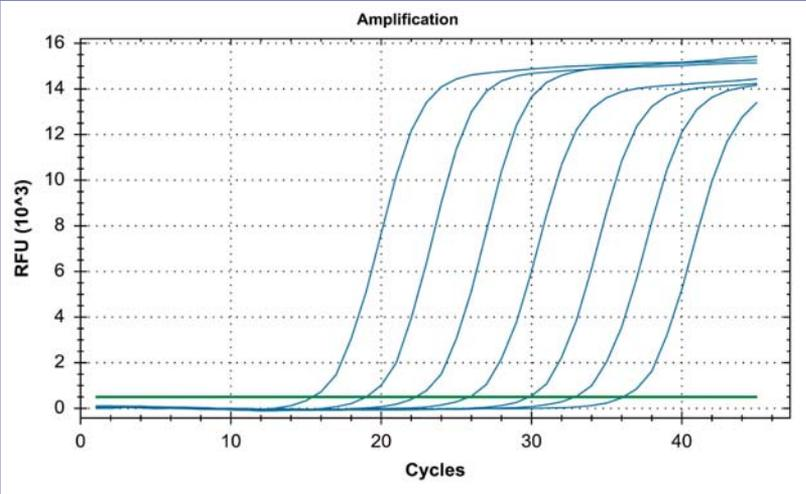
Diluciones seriadas de un estándar de Parainfluenza 1 ( $10^7$ - $10^1$  copias/reacción). Experimento realizado en el equipo Bio-Rad CFX96 Touch™ Real-Time PCR Detection System.
