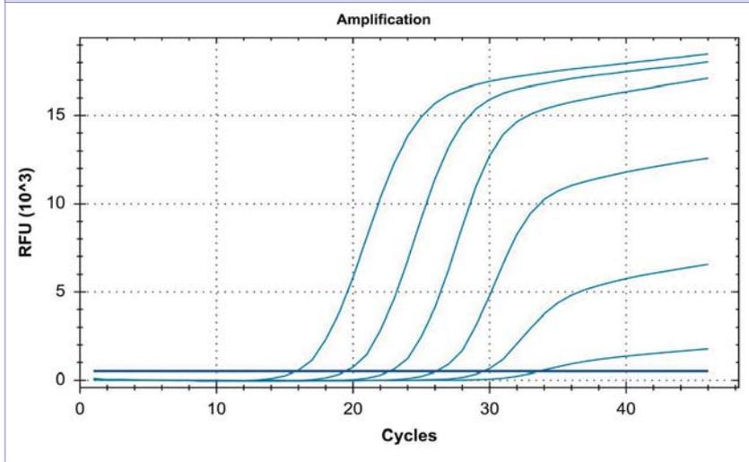
Diluciones seriadas de un estándar de Influenza A ( $10^7$ - $10^2$  copias/reacción). Experimento realizado en el equipo Bio-Rad CFX96 Touch™ Real-Time PCR Detection System.
