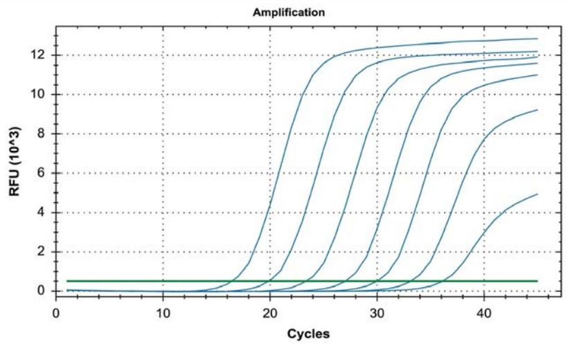
Diluciones seriadas de un estándar de virus *Chikungunya* ( $10^7$ - $10^1$  copias/reacción). Experimento realizado en el equipo Bio-Rad CFX96 Touch™ Real-Time PCR Detection System.
